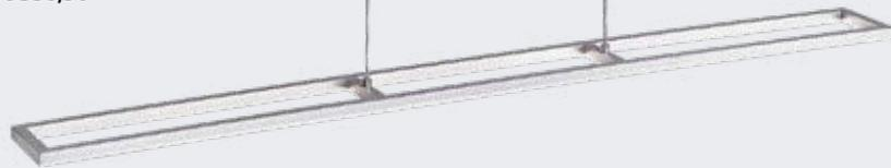
Aluminium gebürstet, Acrylglas satiniert, dimmbar über Phasen- und abschnitt-dimmer, Höhe einstellbar bis max. 200 cm, B. 8 cm, L. 136 cm, inkl. eingebauten **5x8 W LED, 5x595 lm**, Lichtfarbe warmweiß (3000 Kelvin), 5 Jahre Garantie auf LED, EEK A+ (EEK-Spektrum A++ - E)
