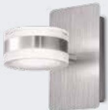
Aluminium gebürstet, Acrylglas satiniert, Up/Down, Leuchtenkopf drehbar, B. 10 cm, H. 17 cm, Ausl. 17,5 cm, inkl. eingebauten **2x8 W LED, 2x595 lm**, Lichtfarbe warmweiß (3000 Kelvin), 5 Jahre Garantie auf LED, EEK A+ (EEK-Spektrum A++ - E)
