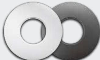
Reduzerring passend für o. g. Downlights mit 114 mm Außendurchmesser zur Abdeckung großer Deckenöffnungen von 105-160 mm, Ø 180 mm
