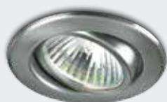
Deckeneinbaustrahler aus hochwertigem **V4A Edelstahl**, schwenkbar 25°, separates Deckenteil des Strahlers ermöglicht Vorinstallation der Leuchte, zum Renovieren wird nur das Vorderteil abgezogen, Deckenausschnitt Ø 68 mm, Einbautiefe 55 mm, Ø 80 mm, für z. B. **8 W LED**, MR16, **GU5,3**, 12 V
